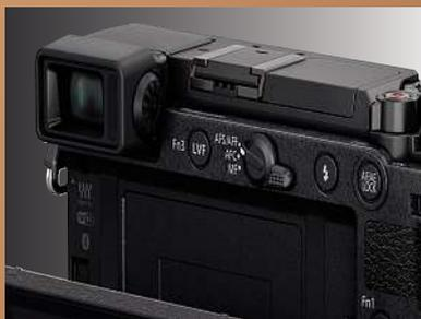
**Bedienvergnügen:** Tasten, Hebel, Einstellräder – rechts neben dem hochklappbaren Sucher liegt eine gut geordnete Vielfalt von Bedienelementen.
