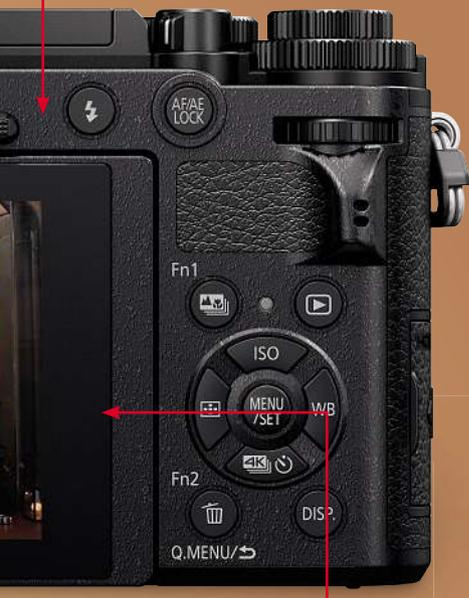
**Kontraststark:** Das als Touchscreen ausgeführte auflösungsstarke LCD lässt sich ausklappen und neigen.
