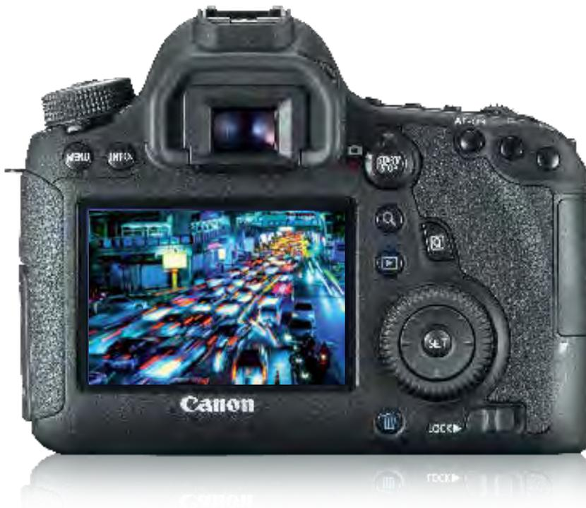
Die Richtungswippe gehört zu den zentralen Bedienelementen der EOS 6D. Sie ist mit dem Daumenwahrad kombiniert und dadurch mit Handschuhen nur recht unpräzise zu bedienen.
