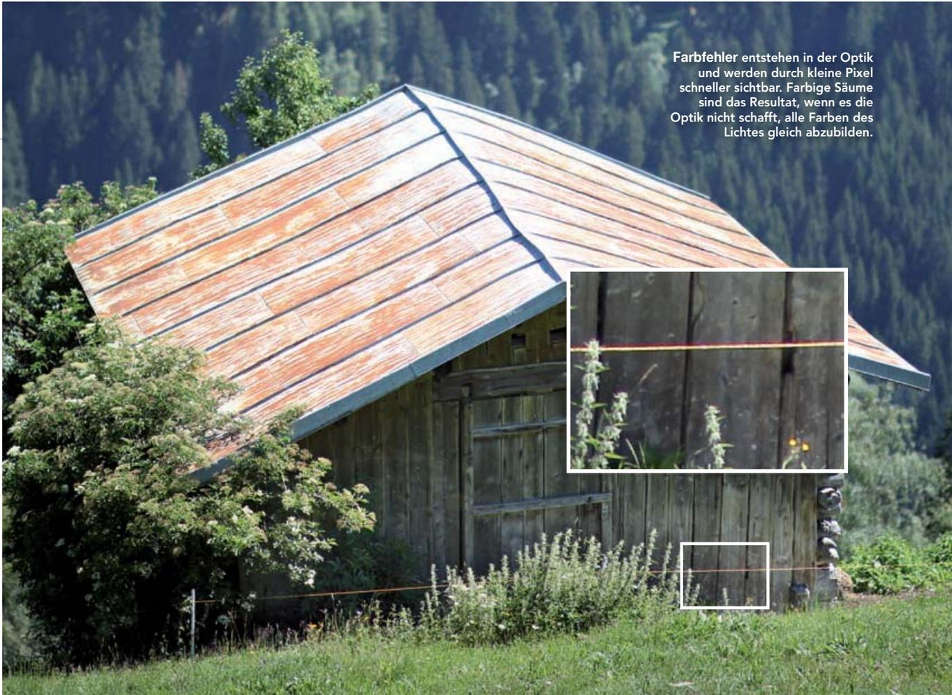
Farbfehler entstehen in der Optik und werden durch kleine Pixel schneller sichtbar. Farbige Säume sind das Resultat, wenn es die Optik nicht schafft, alle Farben des Lichtes gleich abzubilden.
