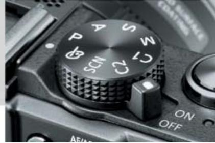
Auf der Wählscheibe für die Belichtungsprogramme finden sich zwei Raststufen (C1/C2) für benutzerdefinierte Kamerakonfigurationen.
