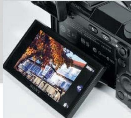
Die NEX-7 verfügt als einzige über einen schwenkbaren Monitor, der jedoch (anders als bei der NEX-5N) nicht berührungsempfindlich ist.
