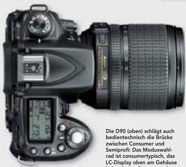
Die D90 (oben) schlägt auch bedientechnisch die Brücke zwischen Consumer und Semiprofi: Das Moduswahlrad ist consumertypisch, das LC-Display oben am Gehäuse haben heute fast nur noch die (Semi-)Profis.
