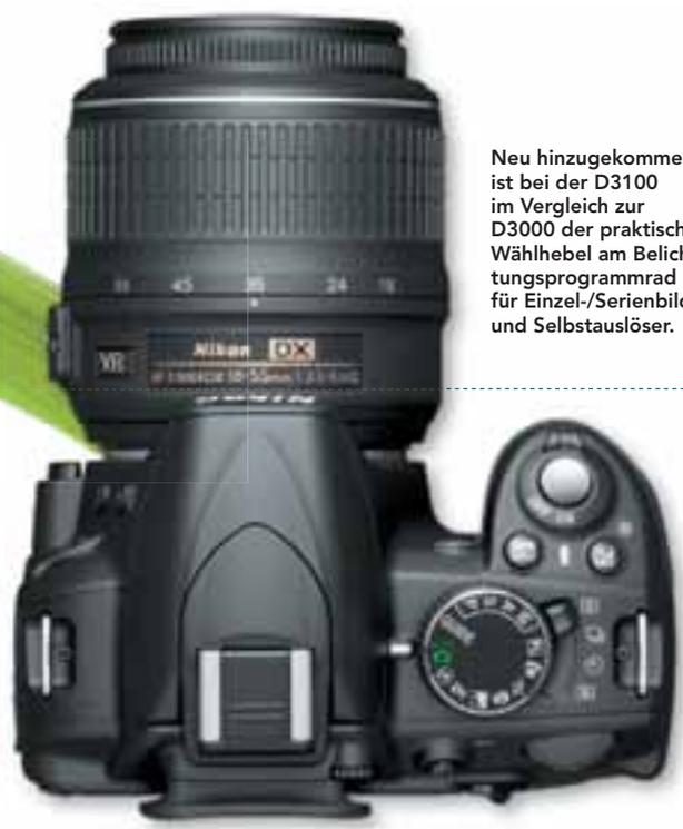
Neu hinzugekommen ist bei der D3100 im Vergleich zur D3000 der praktische Wählhebel am Belichtungsprogrammrad für Einzel-/Serienbild und Selbstauslöser.
