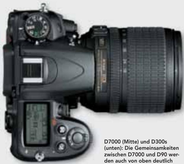
D7000 (Mitte) und D300s (unten): Die Gemeinsamkeiten zwischen D7000 und D90 werden auch von oben deutlich – etwa beim Wahlrad für die Belichtungsprogramme. Bei der D300s findet sich dort ein Multifunktionsschalter.
