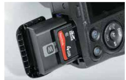
Unter der Abdeckung für das Akkufach befindet sich auch der Slot für die SD-Karte – unpraktisch, wenn die Kamera auf dem Stativ steht und die Karte gewechselt werden muss.
