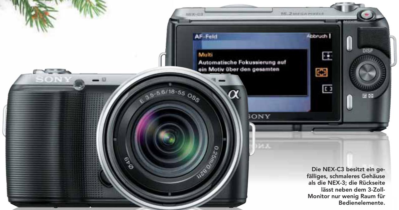
Die NEX-C3 besitzt ein gefälliges, schmaleres Gehäuse als die NEX-3; die Rückseite lässt neben dem 3-Zoll-Monitor nur wenig Raum für Bedienelemente.
