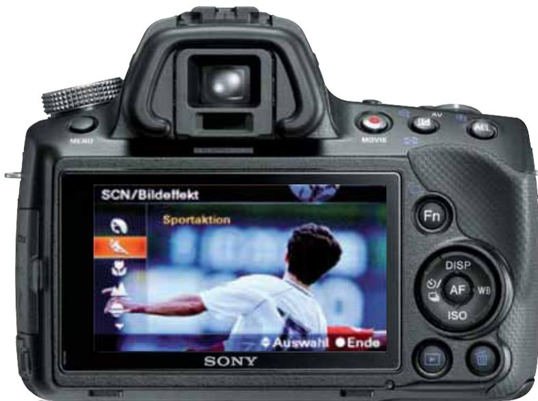
Die Alpha SLT-A35 besitzt als einzige im Testfeld einen eingebauten elektronischen Sucher. Die vielen Tasten erfordern etwas Eingewöhnung, erlauben dann aber eine schnelle und intuitive Bedienung.
